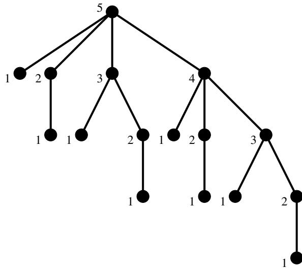
Figura 2.4: A árvore binomial  $T_5$ .
