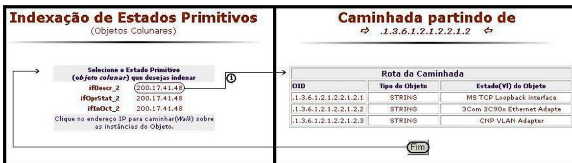
Figura 6.4b - Ilustração de uma caminhada na MIB-2
