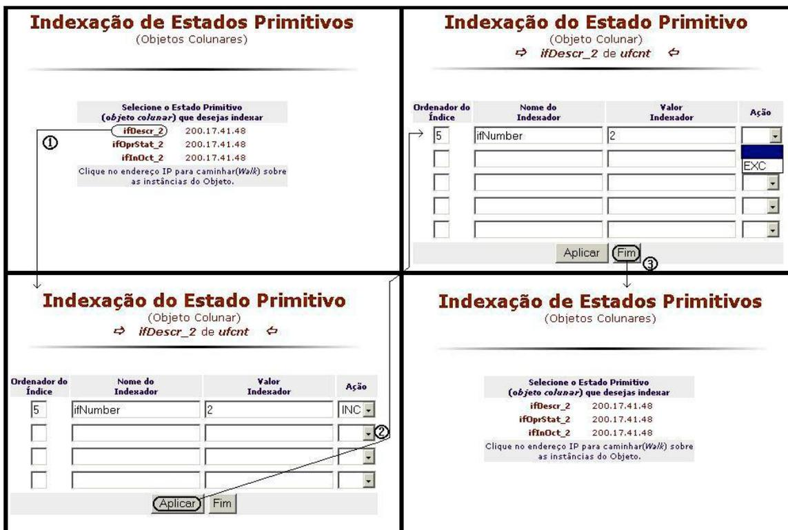
Figura 6.4a - Fluxo típico de indexação de Estados Primitivos no SGME
