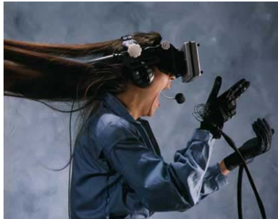
Figura 4: Pessoa utilizando um HMD e um par de datagloves.
