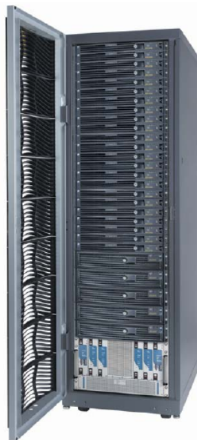
Figura 2.13: Arquitetura de memória distribuída - cluster SGI. Fonte: www.sgi.com .
